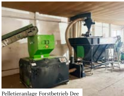
Pelletieranlage Forstbetrieb Dee
